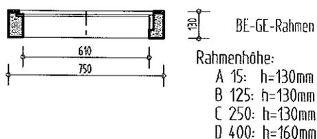
Beton-Gußeisenrahmen (BE-GE-Rahmen) Dn 600mm
