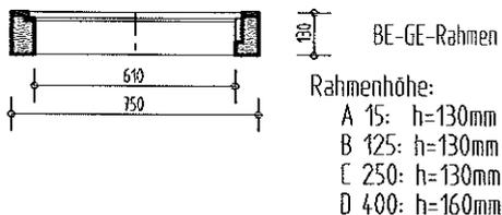
Beton-Gußeisenrahmen (BE-GE-Rahmen) Dn 600mm
